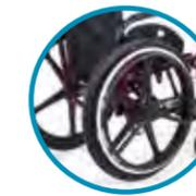
**Ki Mobility - Sistema de manejo Hemi:** Aro de impulso con múltiples opciones de configuración para permitir la auto propulsión con una sola extremidad superior.
