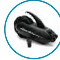
Smart Drive - Power assist: Sistema de ayuda de auto propulsión. Velocidad de 12Km/h. Peso de transporte 5.7kg.
